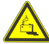
Warnung vor Gefahr durch Batterien W 20 N736 · N737 · N738
